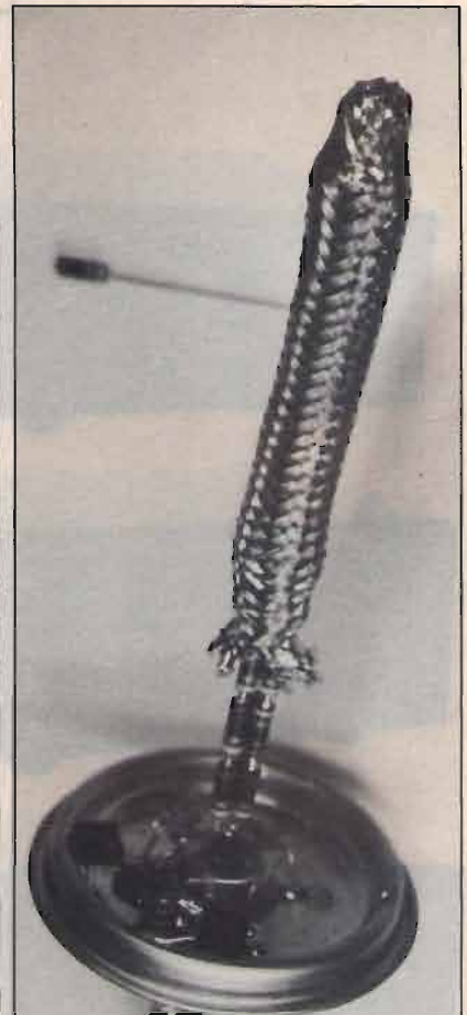
foto 4 La serie dei resistori deve essere incappucciata con una guaina di calza schermante
