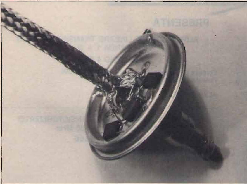
foto 3 Particolare della sezione rivelatrice e di filtro, assemblata in aria sotto il coperchio.
